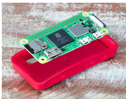
Figure 2-10 Mise en place du Zero dans son boîtier
