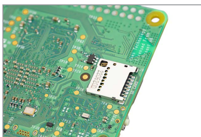
Figure 1-16 Connecteur de carte microSD d'un Raspberry Pi
