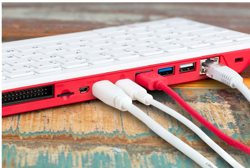
Figure 2-24 Tous les câbles de ton Raspberry Pi 400 sont branchés !
