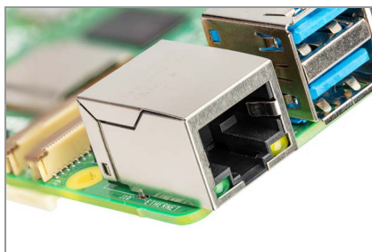
Figure 1-8 Port Ethernet d'un Raspberry Pi
