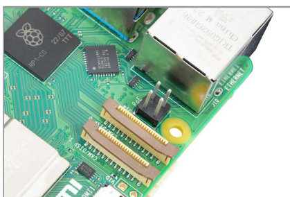
Figure 1-9 Connecteur PoE d'un Raspberry Pi
