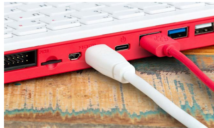
Figure 2-22 Connexion du câble HDMI à un Raspberry Pi 400
