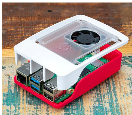
Figure 2-7 Fixation de l'ensemble ventilateur et du cadre
