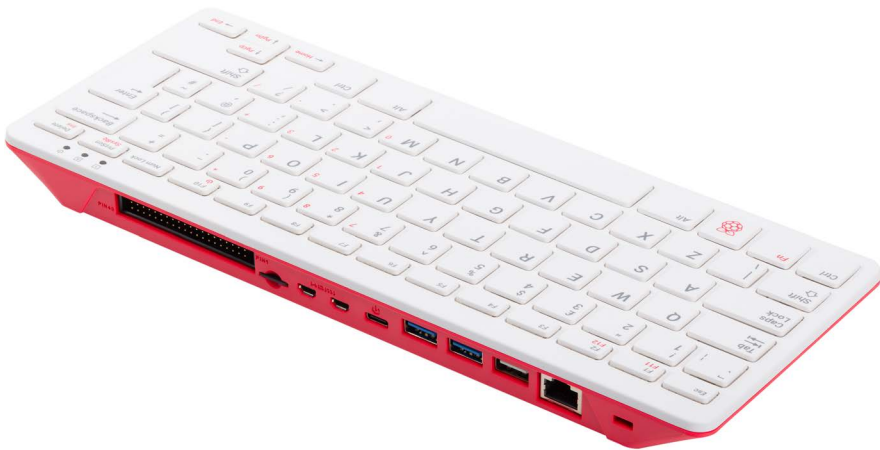
Figure 1-18 Les ports se trouvent à l'arrière du Raspberry Pi 400
