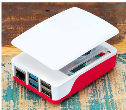
Figure 2-8 Placement du couvercle sur le dessus du boîtier
