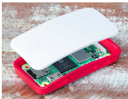
Figure 2-11 Fixation du couvercle
