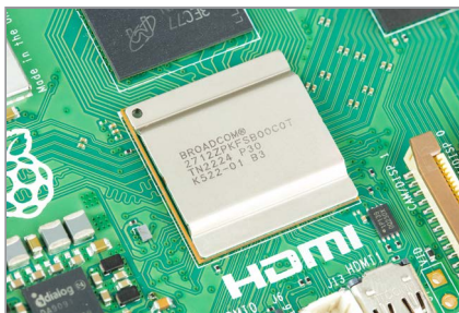
Figure 1-2 Le système sur puce d'un Raspberry Pi (SoC)
