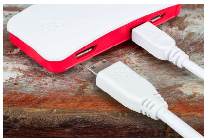
Figure 2-16 Connexion du câble HDMI à un Raspberry Pi Zero
