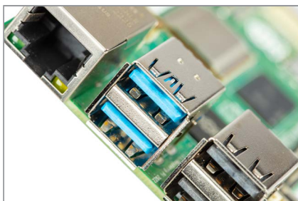
Figure 1-7 Les ports USB d'un Raspberry Pi
